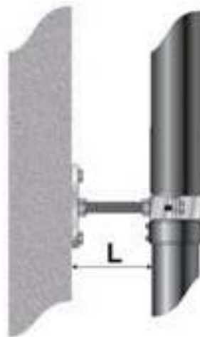
25. ábra: Ejtővezeték rögzítése merev szerkezethez
